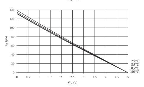
I/O PIN PULL-UP RESISTOR CURRENT vs. INPUT VOLTAGE  $V_{\rm CC}$  = 5V
